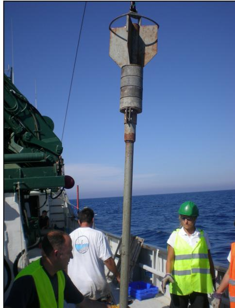
El funcionamiento de este sistema es sencillo. Por medio de una grúa y un winche es izado verticalmente hasta el agua.
