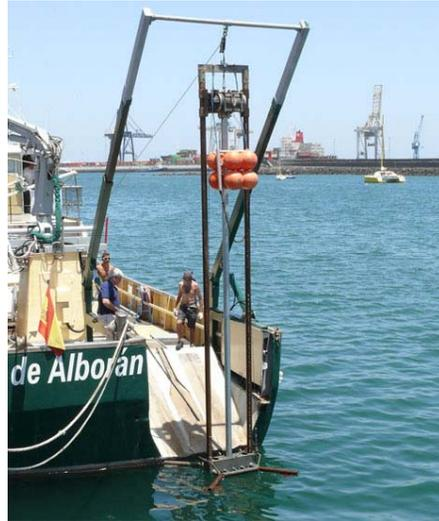
La operativa de funcionamiento es sencilla: una vez que es sumergido el equipo (cabeza y tubo) verticalmente en el agua y éste contacta con el fondo marino, se le suministra corriente de manera que la vibración del equipo permita al tubo receptor de muestras penetrar en el sustrato no consolidado.
